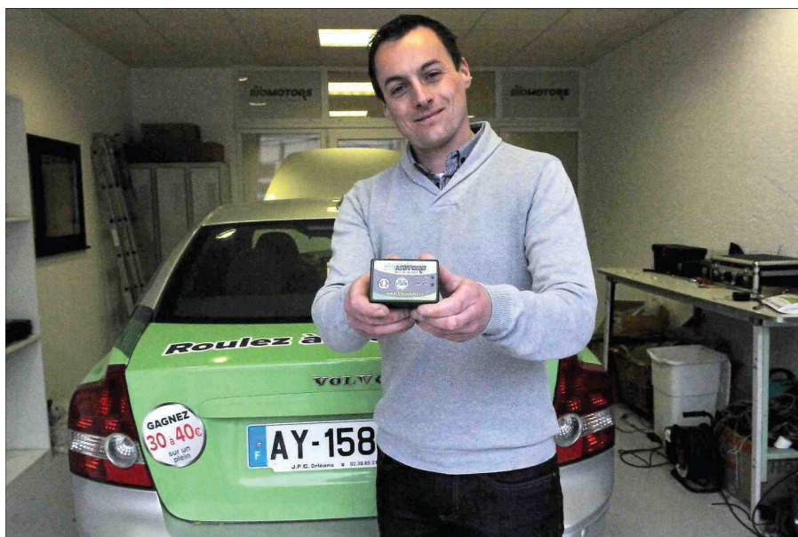
■ Le boîtier de la société montpelliéraine Biomotors s'intercale entre l'ordinateur de bord et le système d'injection.
